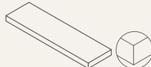
■ Realizzato con sistema di taglio a disco senza bisello. L'eventuale presenza di leggere irregolarità del bordo o di scostamenti dimensionali fino ad 1 mm è da ritenersi conforme.
