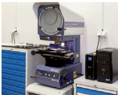
Profilový projektor. Laboratoř oddělení kvality.
