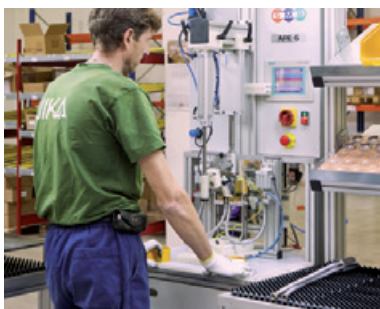
Vzduchový test na montážní lince.
