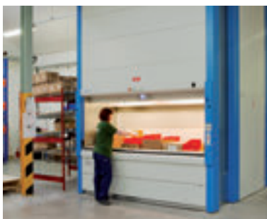
KARDEX. Velkokapacitní automatizovaný skladovací systém.
