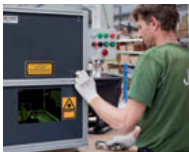
Laser při procesu vypalování loga.
